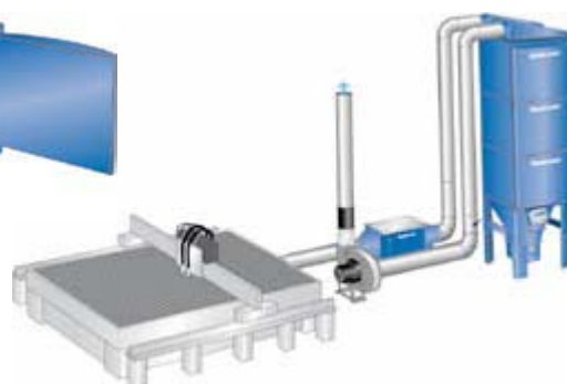
Esempio di installazione di una cabina FilterMax SFC in un impianto di taglio.
