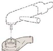
Una calotta in poliuretano resistente deve essere raccordata al carter. Occorre scegliere tra il modello con o senza setole di contenimento, nei diametri 125, 150 e 180mm (5" - 6" - 7").
