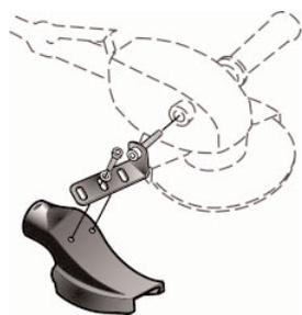
L'adattatore consente di fissare la bocchetta in due posizioni: per dischi Ø180mm (7") oppure Ø230mm (9").
