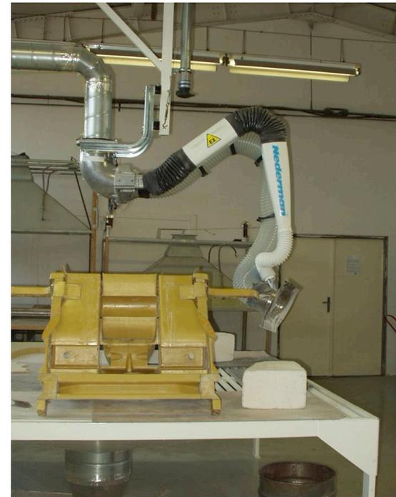
Braccio "D" Atex Komsa utilizzato per la realizzazione di particolari
