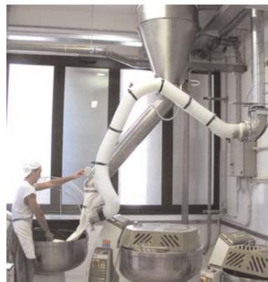
Il braccio Proboscide "D" della KOMSA utilizzato sopra un'impastatrice. La posizione della cappetta è facilmente regolabile.
