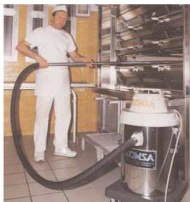
Il KW12 della KOMSA è un aspiratore carrellato progettato per la pulizia dei forni (spenti), in presenza di temperature elevate e per l'aspirazione di residui con temperatura fino a +170°C.
