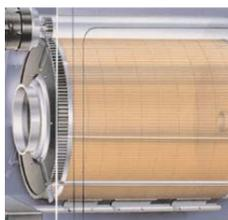
Quando è necessaria la pulizia, un motore ruota la cartuccia-filtro che sbatte contro a dei tamponi, rimuovendo la polvere.
