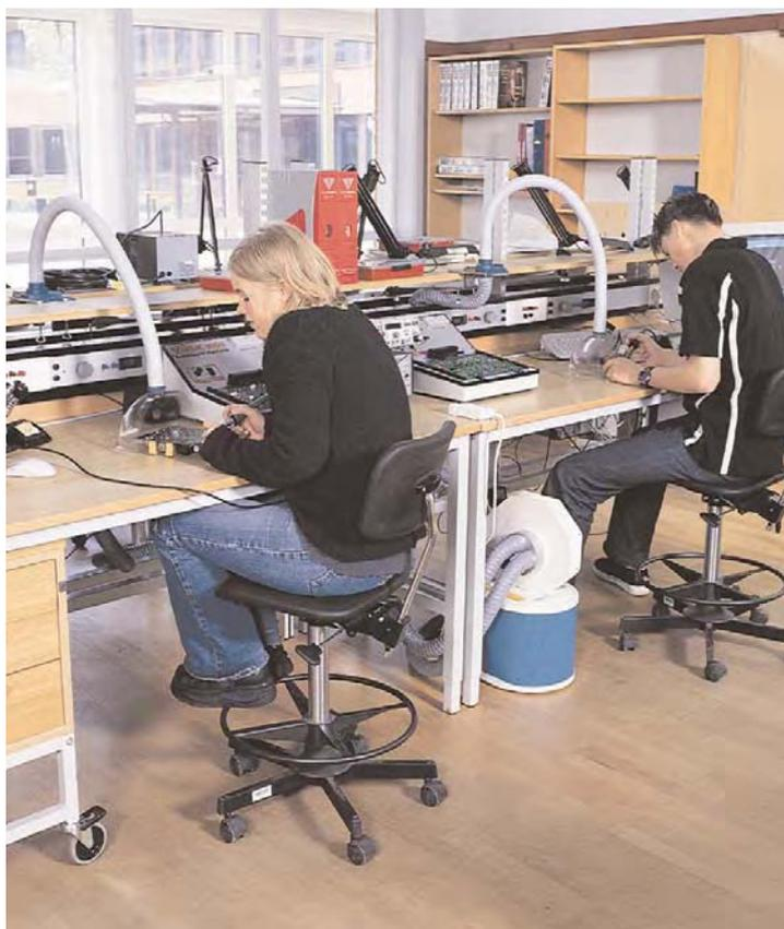
*I braccetti serie KOMSA 32 si fissano con facilità al tavolo di lavoro tramite le staffe a morsetto. In pochi minuti il vostro impianto di aspirazione è pronto per l'uso.*
