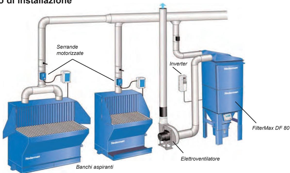
*Esempio di due banchi aspiranti collegati ad un FilterMax DF80 e ad un elettroventilatore centrale serie NCF.*
