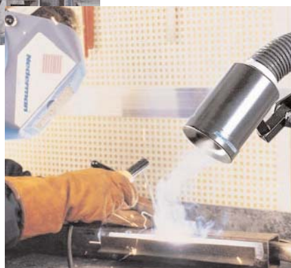
Aspirazione fumi di saldatura con bocchetta.
