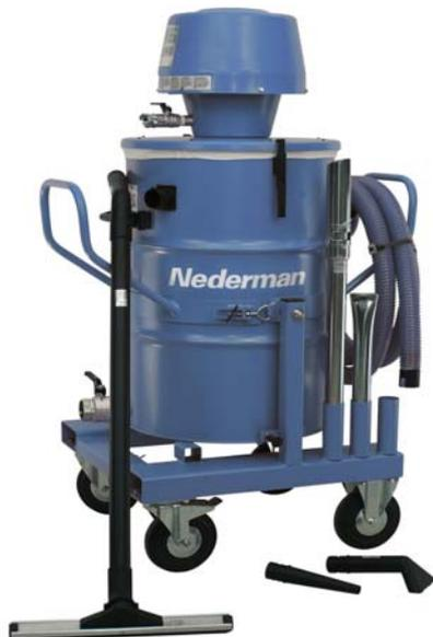
Aspiratore carrellato a contenitore unico, progettato per la raccolta di particelle grossolane, come sfridi metallici e granulati, così come liquidi e fanghiglia. L'alta pressione permette il trasporto del materiale su lunga distanza. Il contenitore di raccolta può essere svuotato facilmente tramite semplice ribaltamento. Può essere fornito con valvola di drenaggio sul fondo per lo scarico rapido dei liquidi. La struttura del carrello consente la movimentazione del filtro tramite muletto.
