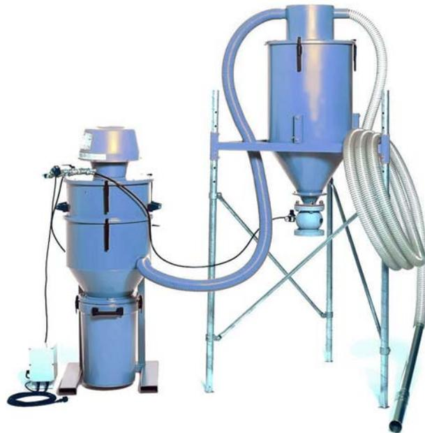
Questo sistema, robusto ed estremamente potente, è progettato per il recupero di materiale per sabbiatura e granulati. E' dotato di valvola a manicotto automatica e di filtro NCF automatico e autopulente. La maggior parte della polvere viene separata dal materiale per sabbiatura o dai granulati. La polvere viene raccolta nell'apposito contenitore, mentre il materiale per sabbiatura o i granulati ritornano nella sabbiatrice, in convogliatori o in altri contenitori.
