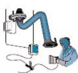
*Un braccio di aspirazione completo di elettroventilatore a controllo automatico. La soluzione perfetta per una postazione di lavoro singola.*
