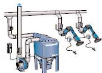
*Una soluzione per grandi officine. I bracci sono collegati ad un impianto centralizzato con elettroventilatore di grande capacità e gruppo-filtro. Le serrandine si aprono e si chiudono automaticamente.*
