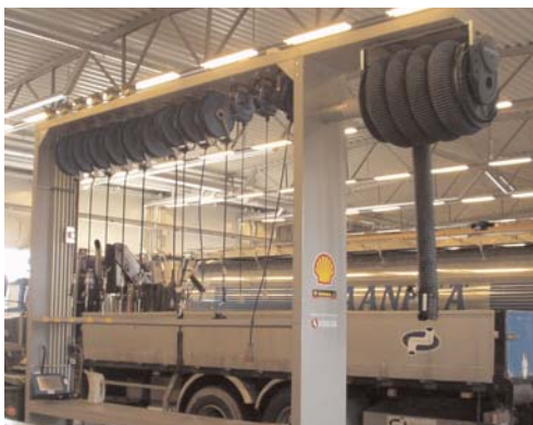
Stazione di manutenzione con arrotolatori per la distribuzione di aria, acqua, olio, grasso e per l'aspirazione di gas di scarico.
