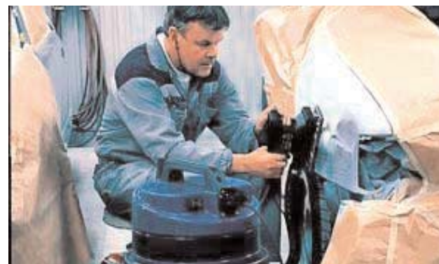
Un aspiratore industriale carrellato collegato ad un utensile elettrico con kit di aspirazione è la soluzione ideale per piccoli lavori di carteggiatura e smerigliatura.
