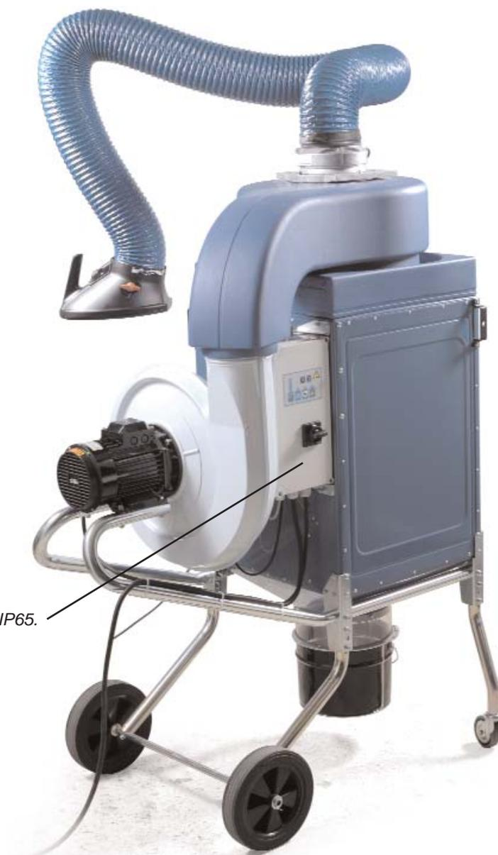
*FilterBox "Monitor" con quadro elettrico IP65.
