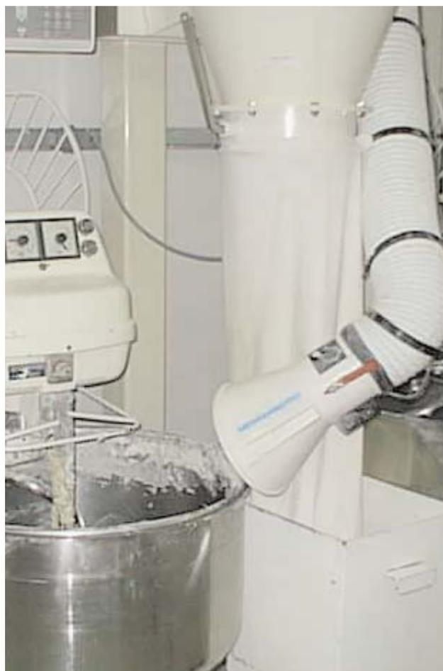
*Un braccio tradizionale Proboscide Friskus utilizzato sopra ad un'impastatrice. La posizione della cappetta si regola con facilità*
