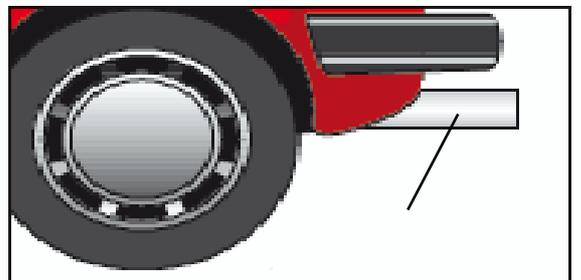
Se possibile, indipendentemente dal tipo di tubo di scappamento, cercate di collegare la bocca con le pinze in posizione estesa. Se la bocca non risulta sufficientemente vicino alla carrozzeria per catturare efficacemente i gas di scarico, occorre regolare le pinze in posizione retratta.
