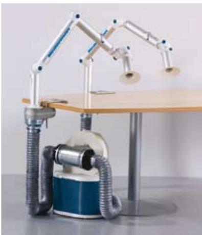
Kit di aspirazione progettato per due postazioni di lavoro, quando è necessaria una portata fino a 75m<sup>3</sup>/h per ciascun braccio. Il Kit è composto da 2 bracci di aspirazione serie BT con giunti girevoli e supporti a banco, un gruppo-filtro con elettroventilatore, due tubi flessibili di raccordo e due bocchette.
