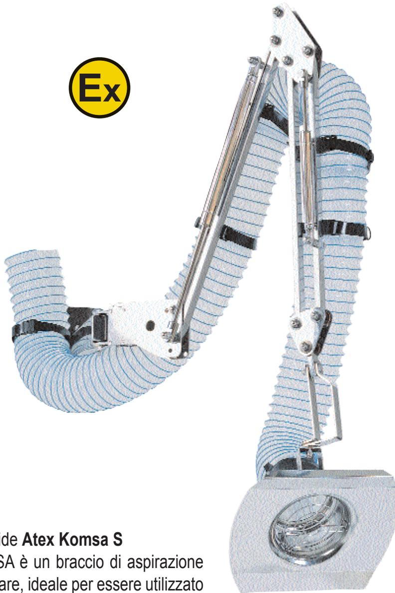
La proboscide **Atex Komsa S** della KOMSA è un braccio di aspirazione facile da usare, ideale per essere utilizzato in ambienti a rischio di esplosione di polveri o gas, o in ambienti con elevata richiesta di igiene.
