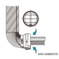
La bocca di aspirazione sovradimensionata permette all'aria ambiente di miscelarsi con i gas di scarico riducendone la temperatura fino al 50% nel punto di aspirazione. In questo modo si allunga la durata dei componenti e si previene il rischio di bruciature.
