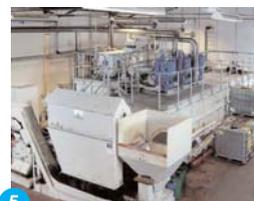
**Sistemi di filtrazione per refrigeranti**
